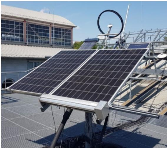
Leistungsprüfstand des Labors für Solare Energiesysteme mit thermisch nachgerüsteten PV-Modulen
