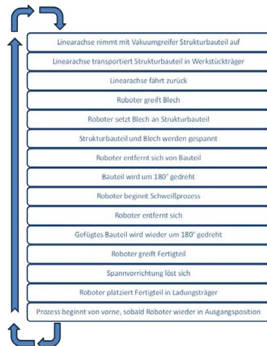
Abb. 2: Ablauf der zu programmierenden Prozessschritte (Quelle: eigene)
