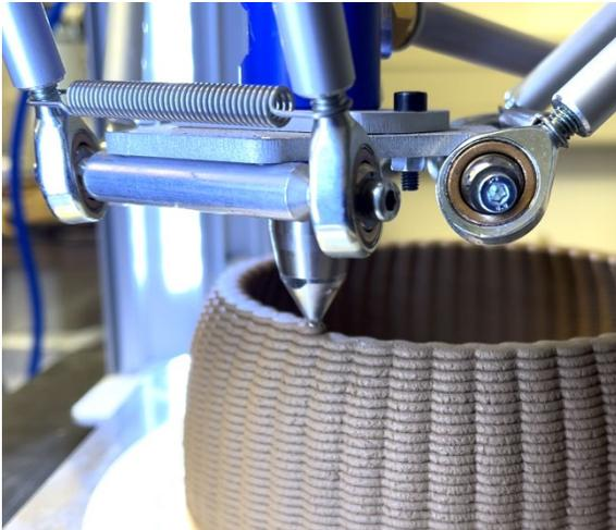
Das LDM-3D-Druckverfahren ermöglicht die digital gesteuerte Verarbeitung von Lehm (Foto: G. Glatz)
