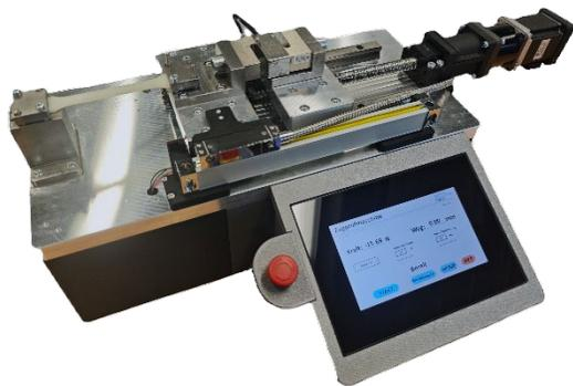
voll funktionsfähiger Prototyp der Zugprüfmaschine
