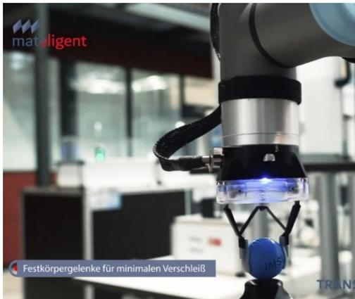
In Montagesystemen und Produktionslinien werden Komponenten unterschiedlichster Größen, Formen und Gewicht von einer zur nächsten Montagestation transportiert. Bei der Handhabung kleinster elektronischer Komponenten wie Mikrocontroller bis hin zu wichtigen Karosserieteilen ist ein optimal an das Bauteil angepasstes Greifsystem von entscheidender Bedeutung. Herkömmliche Greifsysteme sind kaum anpassungsfähig, oftmals schwergewichtig, benötigen Druckluft und arbeiten ineffizient.
